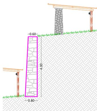
**SEZIONE MURO TIPO 2**
