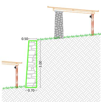
**SEZIONE MURO TIPO 5**
