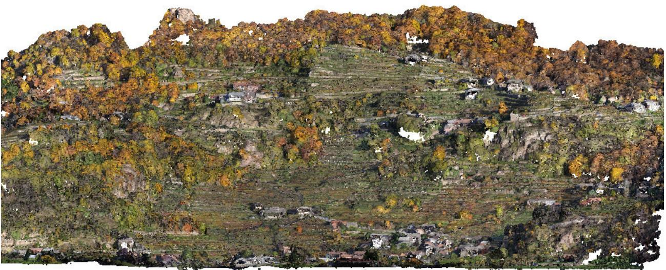
Figura 4- Nuvola di punti derivante dal rilievo del drone - Vista frontale del versante
